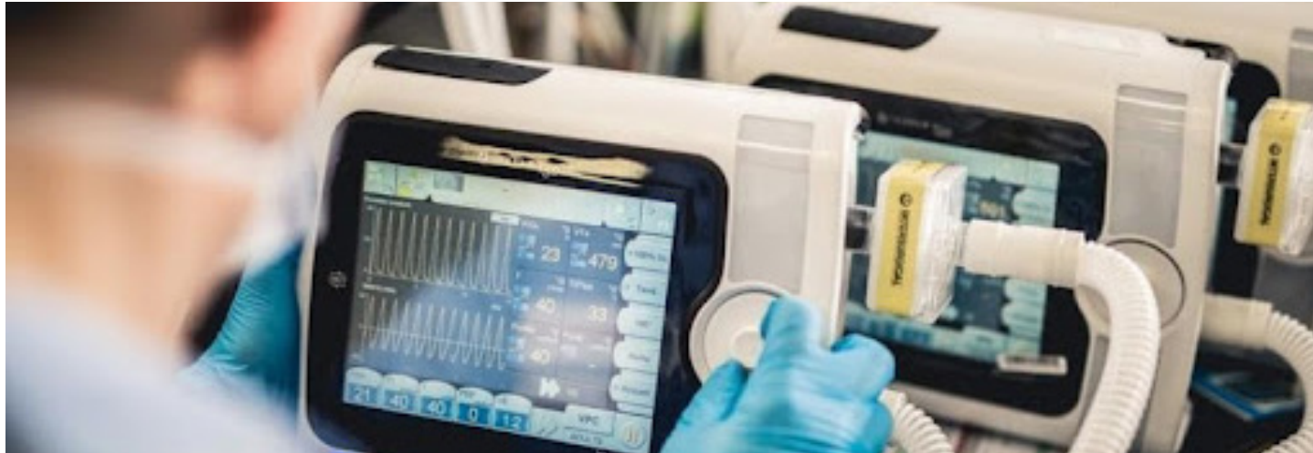
奇美實業 MABS PA-758 塑料製成呼吸器接管件（方形配件，資料來源：Air Liquide 網站）
